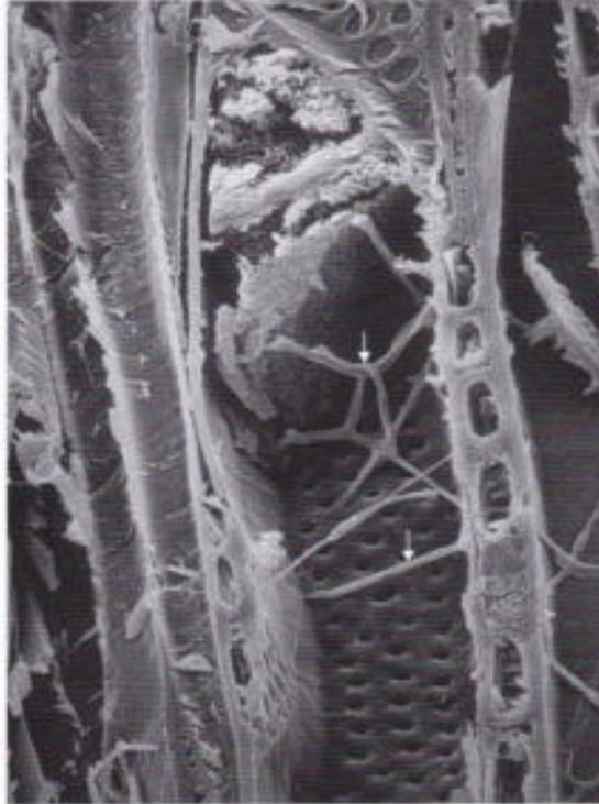
Abb. 51: Das verbleibende Holz wird von holzzerstörenden Pilzen besiedelt. Die Hyphen der Pilze (Pfeil) befinden sich im Zellinneren und durchwachen das vom Baum aufgebene Gewebe. (Pfeile weisen auf die charakteristische Aufnahme, Porensysteme, Tangentialschnitt, aus Driessl et al. 1993).
