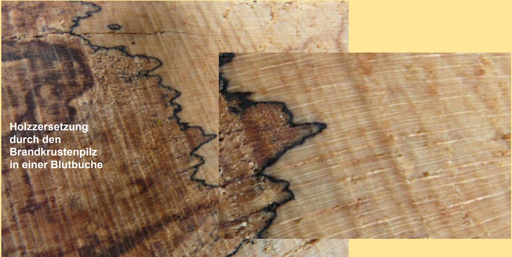
Nach MATTHECK erfüllen die **Holzstrahlen** zusätzlich die Funktion von Mikro-Bolzen. Demnach verbolzen die Holzstrahlen benachbarte Jahrringe (im nicht durchgesägten Zustand sind es Jahrröhren) und verhindern, dass diese gegeneinander verschoben werden. Mit jedem Jahreszuwachs werden die Bolzen verlängert.
