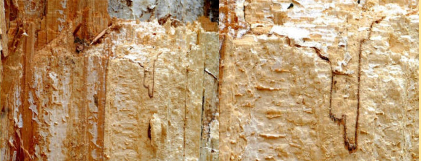
Kommt es zum Ast-, Stämmelings- oder Stammbruch, so geschieht dies in Form eines **Sprödbruchs**. Im Spätstadium kann ein durchschnittliches Starkwindereignis bruchauslösend sein. Das zersetzte Holz weist nur noch eine sehr **geringe Dichte** auf und ist „**federleicht**“. Gut zu erkennen: das weiße Myzel und die dunklen **Demarkationslinien**, die das Ergebnis verstärkter Tätigkeit von Phenoloxidasen sind, welche pilz- oder auch wirtseigene Stoffe in Melanine umwandeln.
